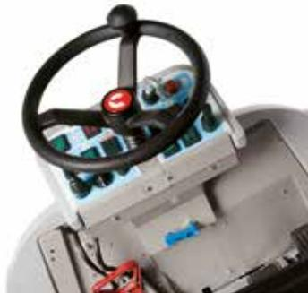
Le panneau de commandes, facile à lire, est placé près de l'opérateur qui peut ainsi contrôler toutes les phases de travail. Un système électronique gère chaque opération de lavage et est accessible par le biais d'un panneau frontal ouvrable.
